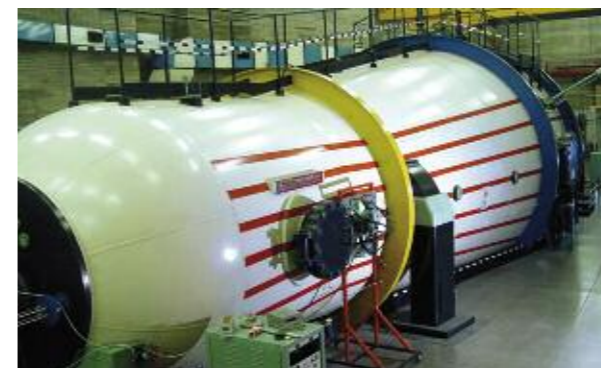
Fig. 4.19: L'acceleratore Tandem Van De Graaff da 15 MV dei Laboratori Nazionali del Sud.
