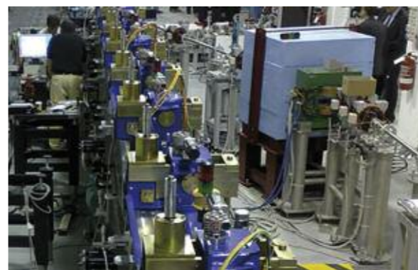
Fig. 4.2: Sala sperimentale dell'acceleratore SPARC. Sono visibili, in primo piano, gli ondulatori.
