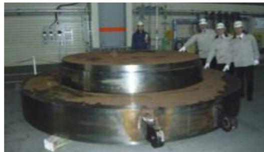
Fig. 3.23b: Ferro del magnete dopo la forgiatura
