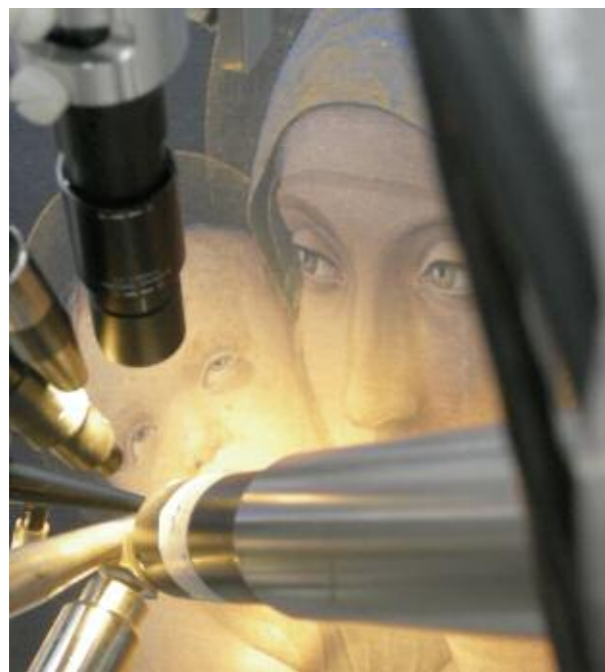
Fig. 3.26: Analisi di composizione dei pigmenti su una tela del Mantegna alla facility di microfascio esterno a scansione del Laboratorio per i Beni Culturali di Firenze (LABEC).
