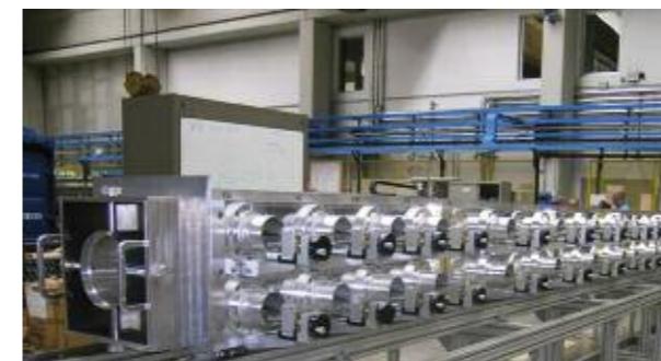
Fig. 4.15: Il modello in alluminio, scala 1:1 dell'acceleratore RFQ per IFMIF.
