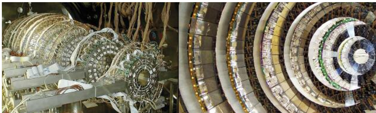
Fig. 4.22 a) e b): Vista esterna e vista interna del rivelatore di particelle cariche CHIMERA ai Laboratori Nazionali del Sud.
