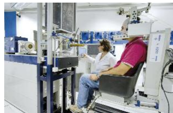
Fig. 4.24: Particolare della linea di fascio CATANA (LNS) per la terapia del melanoma oculare.
